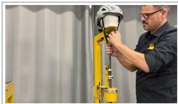
ADAC-Test Fahrradhelme (2024): Kinnriemenprüfung.
