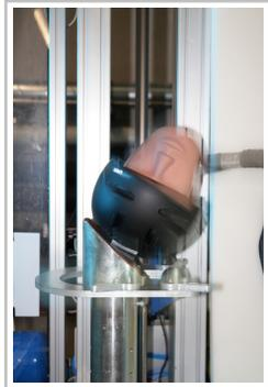
ADAC-Test Fahrradhelme (2024): Fallprüfung.
