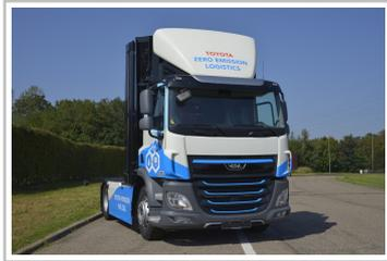
Brennstoffzellen-Lkw von VDL mit Toyota-Technik.
