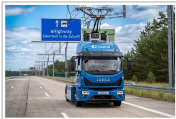
PEM-Projekt der RWTH Aachen demonstriert fahrtaugliche Elektro-Lkw mit Oberleitungsstromabnehmer (Pantographensystem).
