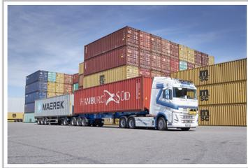
Im Hafen von Göteborg wird ein Volvo FH Electric 6X4 mit zwei Anhängern und einer Gesamtlänge von 32 Metern eingesetzt.
