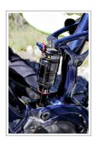
Der ADAC hat acht E-MTB getestet: Das Giant Stance E+ Pro 0 hat an der Kolbenstange des hinteren Dämpfers eine Skala zur Einstellung.
