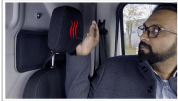
Ford hat die gezielte Wärmeabgabe an bestimmten Stellen der Fahrzeugkabine eines E-Transit getestet, um Elektrotransportern zu mehr Reichweite zu verhelfen.
