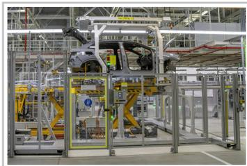
Produktion des VW ID 4 in Emden: Die Batterie wird eingesetzt.
