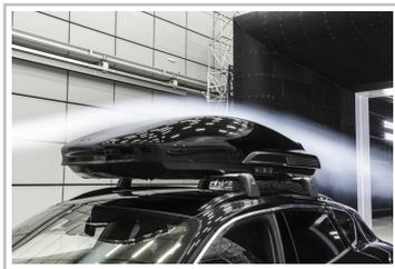
Die Performance-Dachbox von Porsche wurde im Windkanal getestet und ist für Geschwindigkeiten bis 200 km/h freigegeben.
