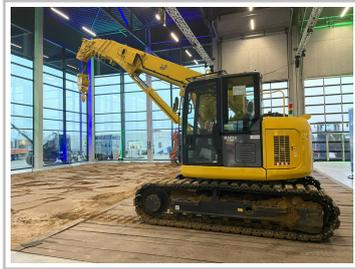
Elektrischer Miniraupenkran Maeda CC 1485 mit Deutz-Motor.
