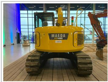
Elektrischer Miniraupenkran Maeda CC 1485 mit Deutz-Motor.
