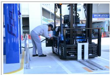
Toyota-Gabelstapler mit Brennstoffzellenantrieb.
