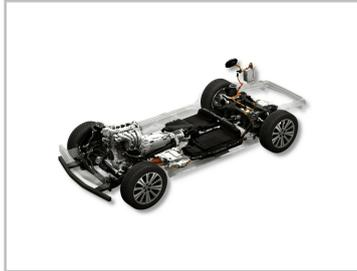
Mazda-Plattform für Plug-in-Hybrid-Antrieb.
