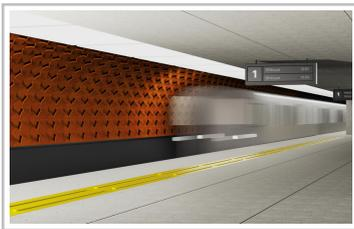
Für den Lexus Design Award 2021 nominiert: Verdunstungskühlsystem aus Terrakotta für U-Bahn-Stationen, das den vom Zug erzeugten Wind nutzt.
