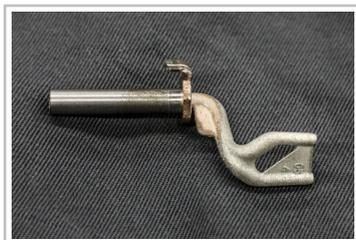
Kolben aus dem 3-D-Drucker: Diese Extrateil der Wasserkühlung wird nicht mehr gebraucht. Es entsteht beim Druck.
