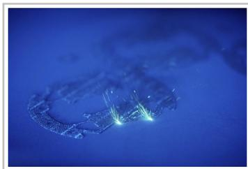
Kolben aus dem 3-D-Drucker: Laser bei der Arbeit.
