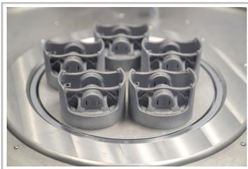
Kolben aus dem 3-D-Drucker: Fünf Rohkolben aus dem Tray aus dem Drucker.
