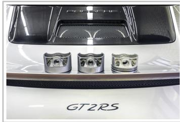
Kolben aus dem 3-D-Drucker: Vom Rohling zum fertigen Kolben.
