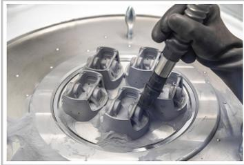
Kolben aus dem 3-D-Drucker: Fünf Rohkolben verlassen den Drucker - der restliche Metallstaub muss weg.
