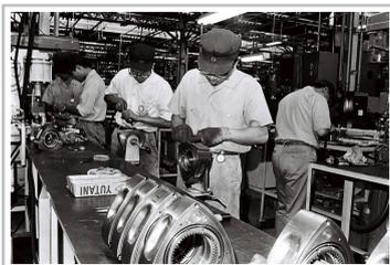
Produktion von Wankelmotoren bei Mazda in den 1960er-Jahren.
