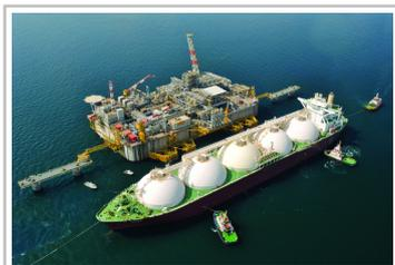
Tanker für flüssiges Erdgas (LPG) an Verladestation.
