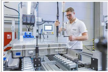
Produktion von Serien-Batteriesystemen bei Akasol.
