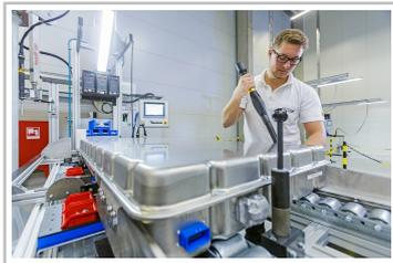
Produktion von Serien-Batteriesystemen bei Akasol.
