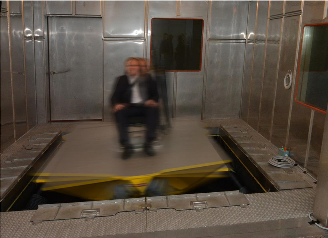
Hydraulischen Hochfrequenz-Schwingprüfanlage (engl. Shaker) von Johnson Controls für Autositze.
