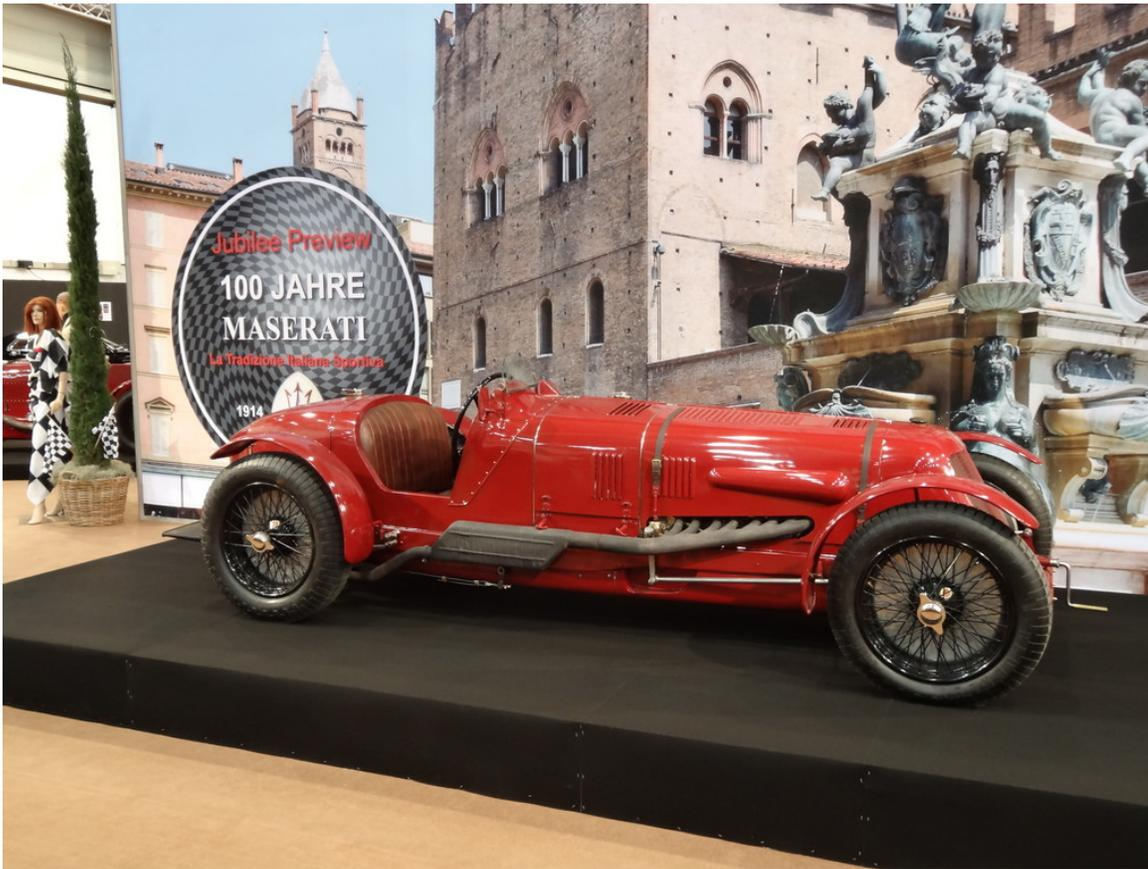
Eindrücke von der Essen Motor Show: Maserati Tipo 4 aus dem Ende der 20er Jahre mit 16 Zylindern, 3961 ccm Hubraum, 304 PS, 260 km/h.
